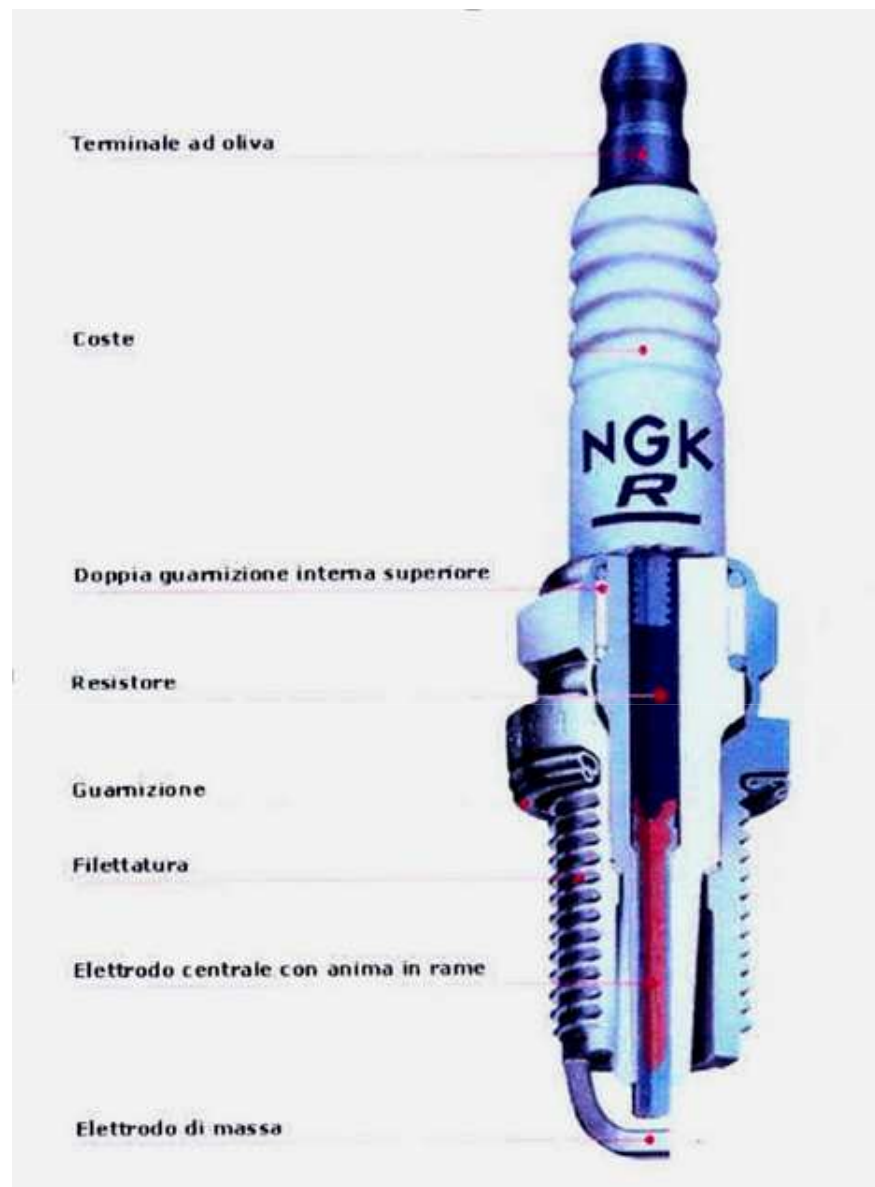
SPACCATO DI UNA CANDELA NGK DI ALLUMINA
